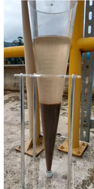
Ilustración 25. Cono de Sedimentación de Imhoff de un Reactor estabilizado después de 30min
