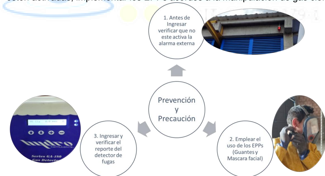
Ilustración 35. Recomendaciones de Seguridad en la caseta de cloración
